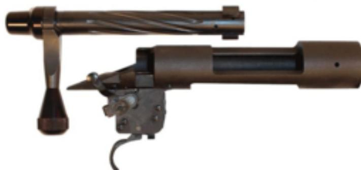
forma cilindrica, all'interno della quale scorre l'otturatore; questo è costituito da un cilindro in acciaio speciale, all'estremità del quale sono poste due o più alette che ruotando di un certo angolo per mezzo di un manubrio sporgente, vanno ad inserirsi in appositi recessi, ricavati nell'azione stessa o nella canna e così chiudere la munizione all'interno della camera di cartuccia.
