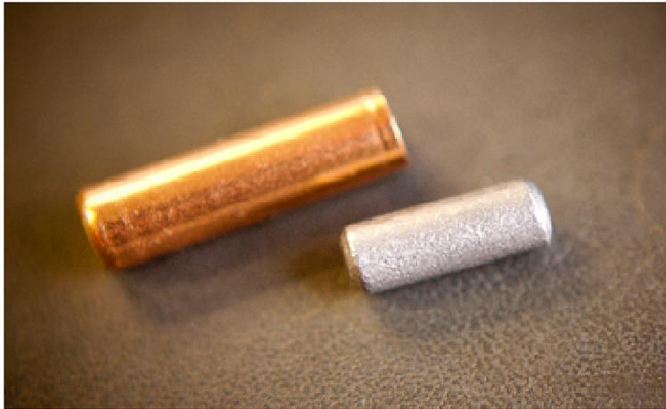
***Mantello e cilindretto in Pb da inserire all'interno***
